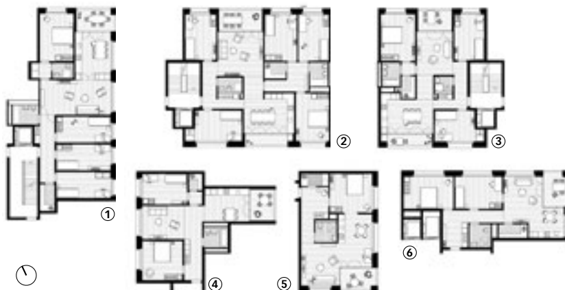
«Mira», Grundrisstypen, Mst. 1:500. Zwei SWfK 5.5-Zimmer-Wohnungen ① ②; LVZ 4-Zimmer-Wohnung ③, LVZ 3-Zimmer-Wohnung ④; SAW 2.5-Zimmer-Wohnung ⑤; SAW 3-Zimmer-Wohnung ⑥.
